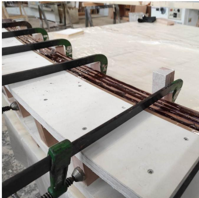
Per dar forza allo scafo, come vuole la tradizione veneziana, sono stati realizzati bottazzi di trincarino, bottazzi di ginocchio, rivestimento chiglia e pattini, tutti in mogano e rivestiti in buona parte mediante cappelletto in acciaio inossidabile.
